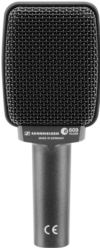
Das e 609 silver ist ein dynamisches Mikrofon mit Supernierencharakteristik. Es bietet einen besonders direkten Klang bei der Abnahme von Gitarrenverstärkern. Es ist mit einer sehr leichten Spule und einer starren Kalotte ausgestattet. Dadurch verfügt das Mikrofon über einen weiten Hochtonbereich.
