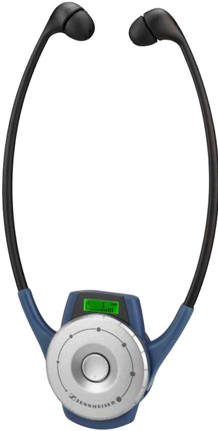
HDE 2020-D, der angenehm zu tragende Kinnbügelhörer des TourGuide Systems 2020-D kombiniert Empfänger und Kopfhörer. Die leistungsstarke Batterie des Hörers sorgt für bis zu 8 Stunden Betriebsdauer, damit wird selbst eine ganze Tagestour durch eine Kulturstadt oder ein Großunternehmen möglich.
