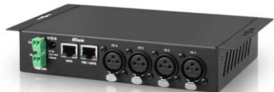
El SL DI 4 XLR incorpora cuatro entradas MIC/LINE simétricas, siendo posible activar para, cada una de ellas, diferentes ajustes de ganancia a través del software, así como una energía phantom de 48 V también individualmente.
