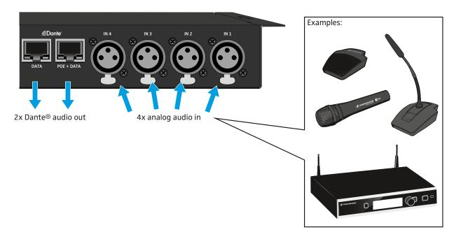
Über die beiden Ethernet-Buchsen DATA und POE + DATA werden die Audiosignale per Dante™ an ein Dante™-fähiges Gerät übertragen.
