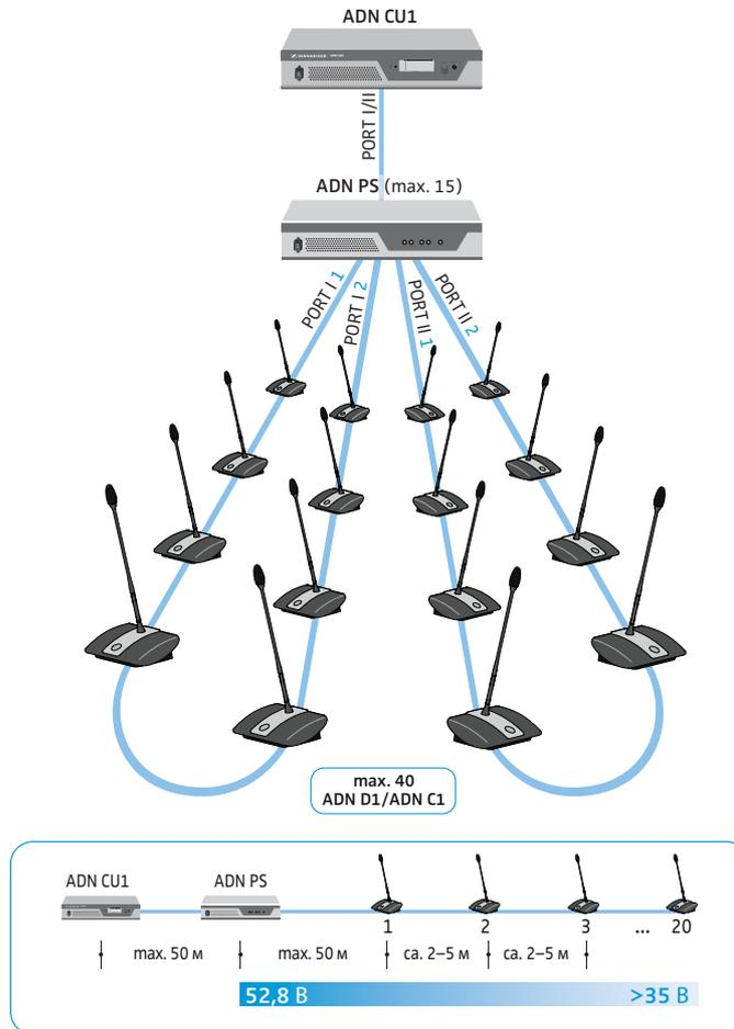
**i** An jeder Spannungsversorgung ADN PS können Sie die verschiedenen Aufbauformen (einfache Verkabelung mit Kabelsträngen oder redundante Ringverkabelung) mischen.
