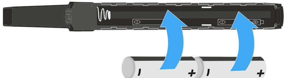
**Para inserir o compartimento para pilhas B 60 no emissor portátil SKM 6000:**
