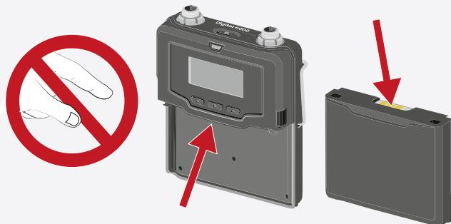
Antes de utilizar o compartimento para pilhas, deve inserir as pilhas conforme ilustrado na figura.
