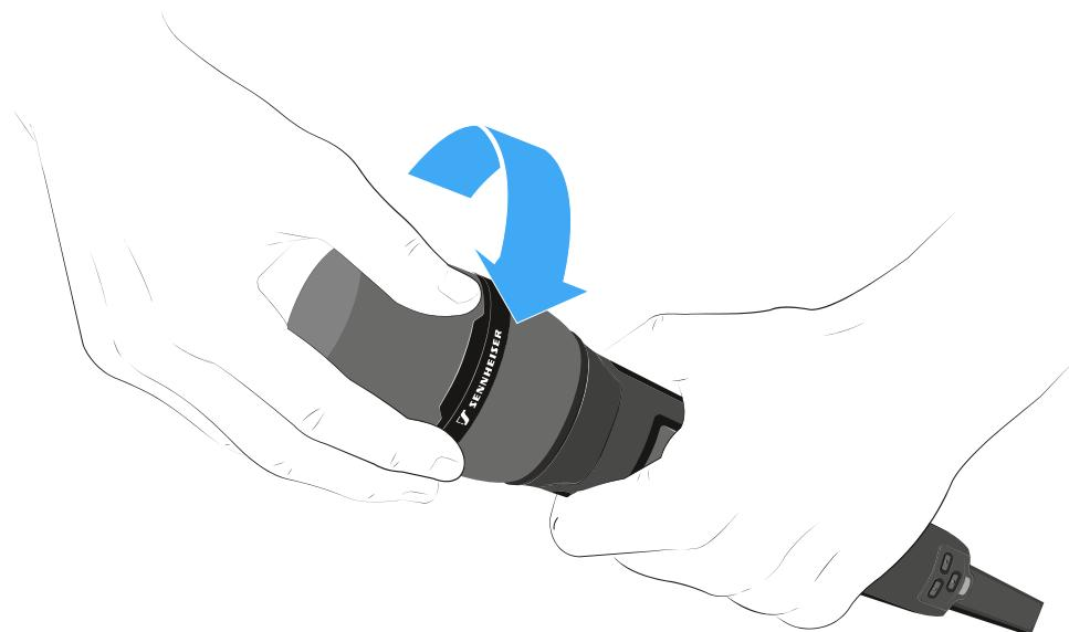
**i** Em certos modelos de módulos de microfone é possível desenroscar a parte superior da grelha do microfone. Certifique-se sempre de que desenrosca completamente o módulo de microfone.
