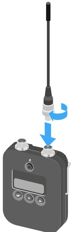
**i** A antena só pode ser encaixada muito facilmente numa posição na tomada de antena. Encaixe a antena com cuidado na tomada de antena do emissor de bolso.
